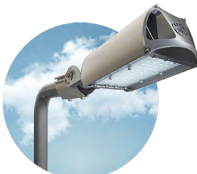
Консоль F3 (Ø35 - Ø66 мм) регулируемое (от +45° до -90°)
